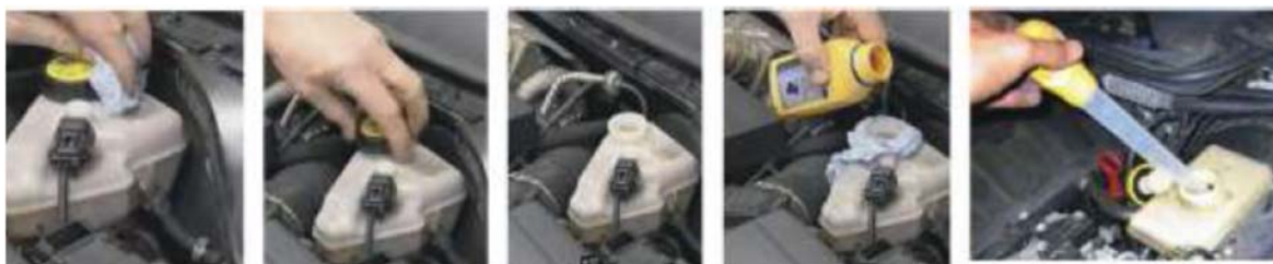
Поступак контролисања нивоа уља у кочионом и серво систему
