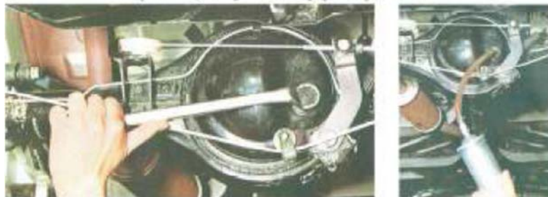
Одврање завртња ба кучишту диференцијала Досипање уља Контрола нивоа и замена уља у диференцијалу
